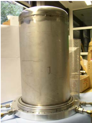
Fig. 4: Foto der Wärmeisolationshülle aus rostfreiem Stahl zu den Wärmetauscher-Patronen.
