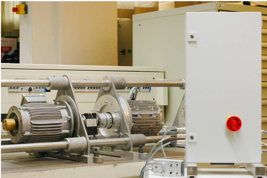
Abbildung 90. Mechanischer Aufbau der Maschinen, links BLDC DM-SNP (IEC90), rechts BLDC CM-IEC-3KW-v2 (IEC100)
