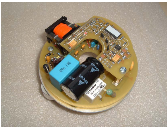
Abb 8/9 Elektronik zum Funktionsmuster mit Leistungs- und Controllerprint.
