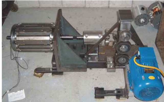
Abb 6: Lineargenerator auf dem Prüfstand angetrieben über ein Rhomben-Zahnriemengetriebe.
