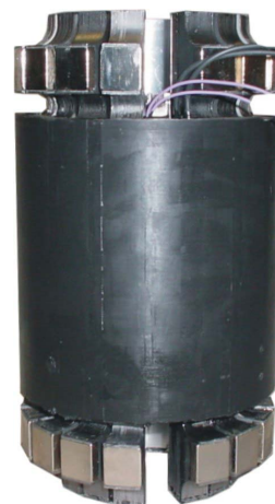
Abb 4: Stator in Epoxyd vergossen
