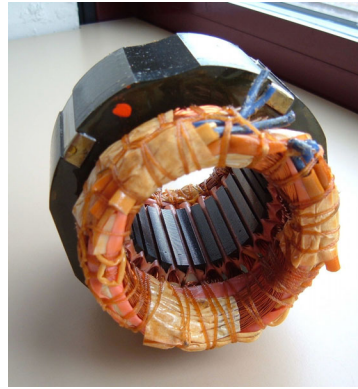
Bild 15/16. Seiten- und Frontansicht des Stators des Normmotor Nr 1.
