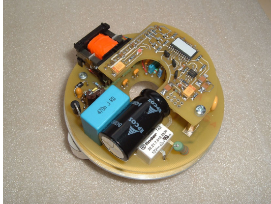
Bild3. Elektronik zum Funktionsmuster mit Leistungs- und Controllerprint.
