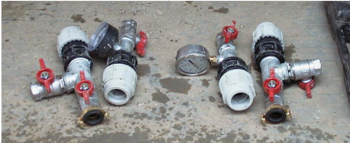
Figur 7: Einfache Prüfgarnitur (Durchfluss- und Druckprüfung) zur direkten Ankoppelung an den Erdwärmesonden-Kreis.
