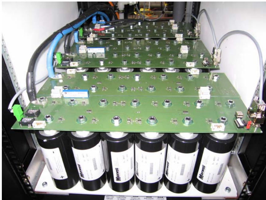
Fig. 3: Einbau der Supercapazitäten
