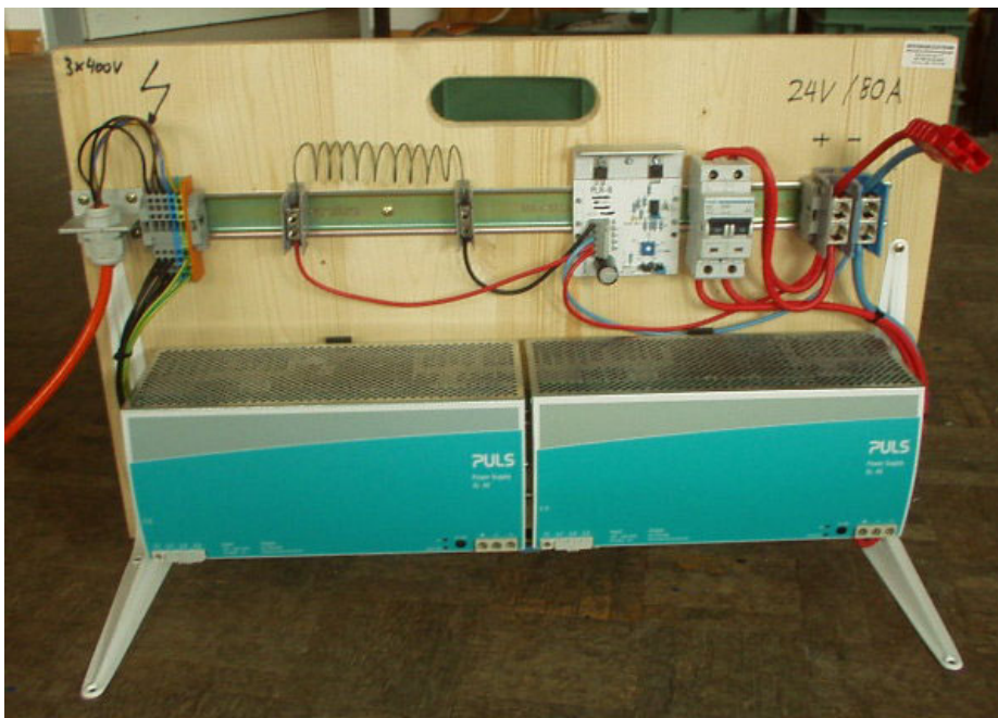
Fig. 25 24V / 80A Stromversorgung mit Bremschopper Foto: Brückmann
