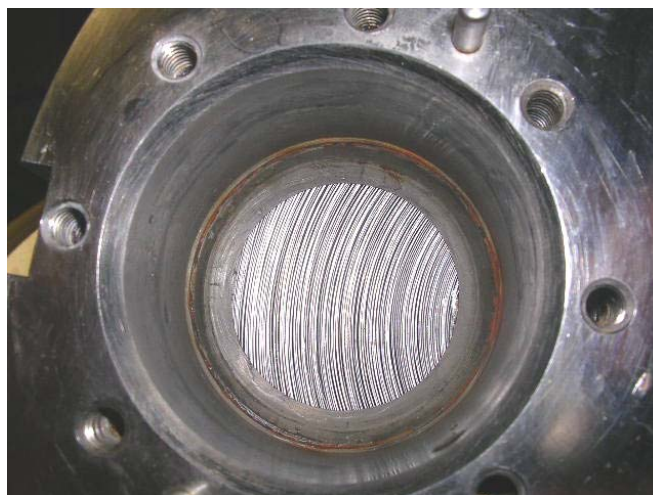
Fig. 3: Blick auf den Wärmetauscher durch das Loch für das Ausgangsventil (Foto: Brückmann)
