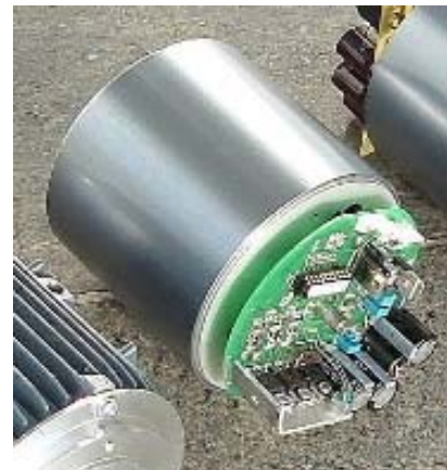
Fig. 11 Elektronik an Motor angebaut Photo: Lindegger
