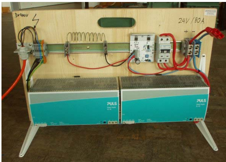
Fig. 13 24V / 80A Stromversorgung mit Bremschopper Foto: Brückmann
