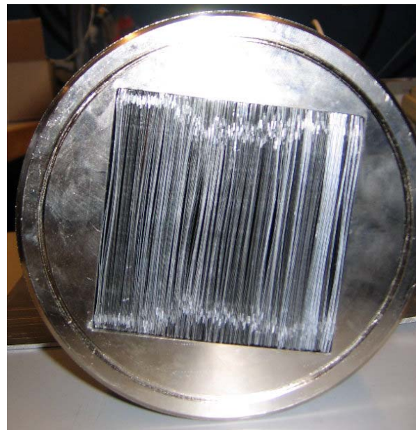
Fig. 2 Wärmetaucher im Flüssigkolben Foto EPFL
