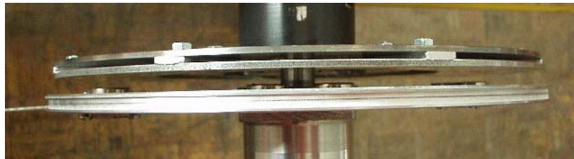
Fig. 17 Radialansicht der Drehmomentwaage Foto: Brückmann
