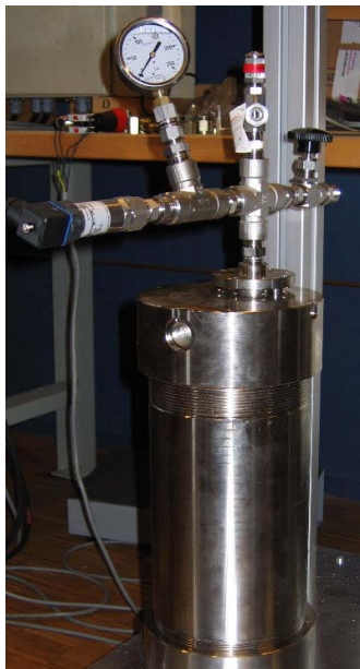
Fig. 1 Flüssigkolben mit Wärmetaucher Foto EPFL
