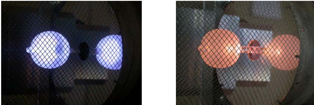
Figure 16 Allumage à moins de 100 W des bulbe-antennes de 2,9 cc rempli à 2,3 mg au tellure (à gauche) et au sélénium (à droite). Ces bulbes ont été sablés.
