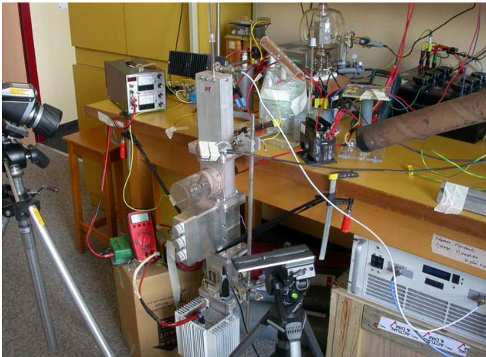
Figure 3 Vue de la paillasse d'expérimentation. A gauche : nouvelle caméra infrarouge. Au centre : guide d'onde accordable couplée à la cavité grillagée contenant le bulbe. En haut à droite : tube photométrique. En bas à droite : amplificateur RF 100 W.
