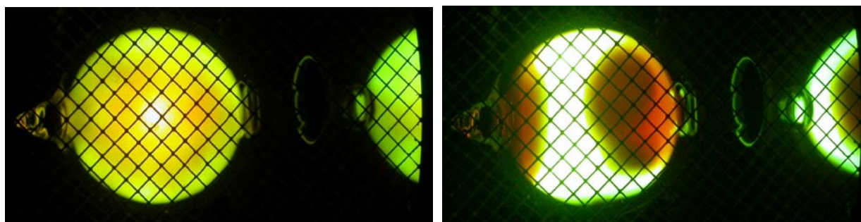
Figure 18 Plasma de tellure, bulbe 8 cc, teneur 6 mg/cc. ~770W, 850°C. A gauche : 40 kHz. A droite : ~15 kHz. Photos prises avec filtre.
