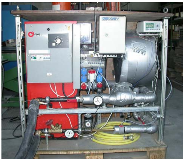
Figure 1: Module de chauffage de l'EPFL pour la réalisation de tests de réponse thermique du terrain
