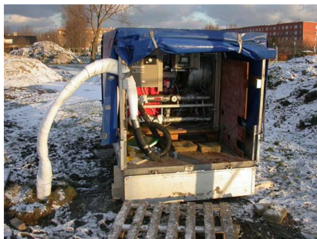
Figure 2: Module de l'EPFL sur sa remorque de transport lors de la réalisation d'un test de réponse à Dunkerque (F)
