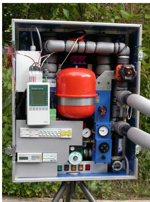
Figure 8: Vue du mini-module de chauffage terminé, dans sa valise de transport.
