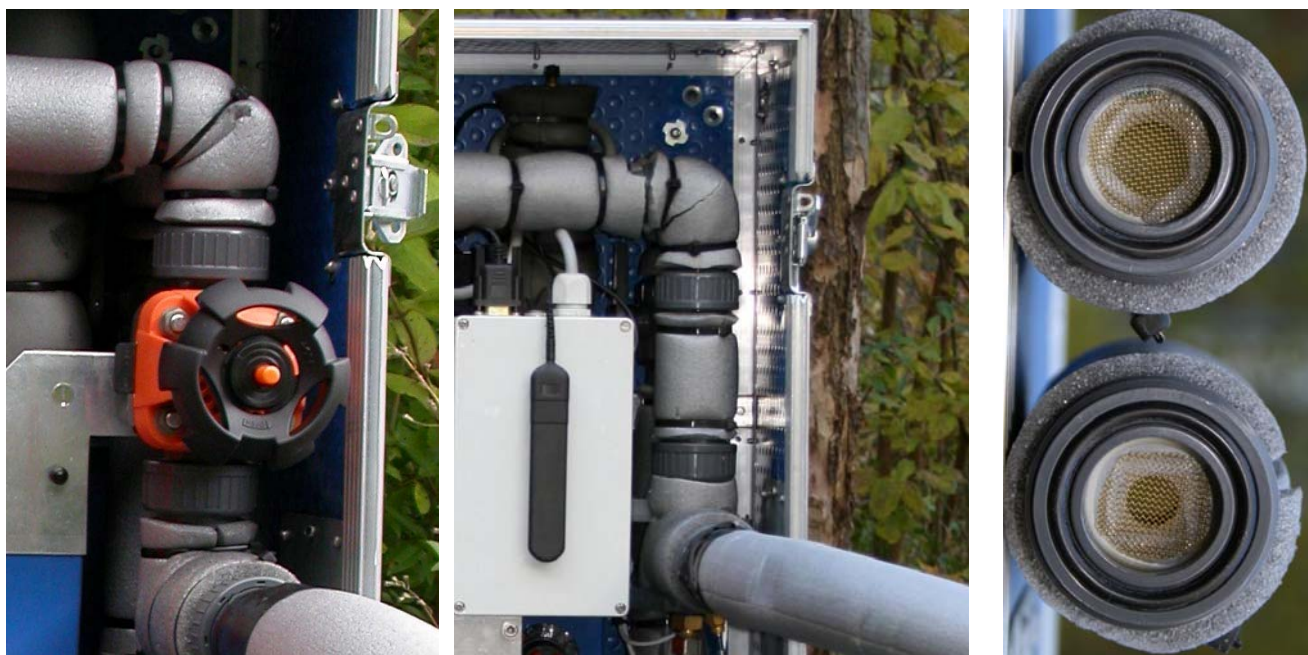
Figure 4: A gauche: Ancienne vanne de réglage du débit. Au centre: Tube de régulation du débit mis en place. A droite: Exemples d'ouvertures des tubes avec les filtres à particules.
