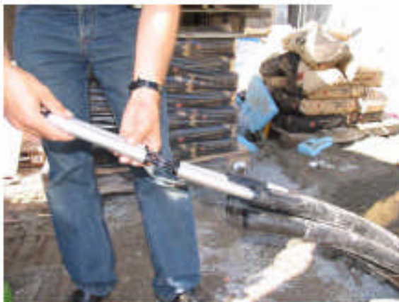
Figur 7: Einschieben der Messsonden
