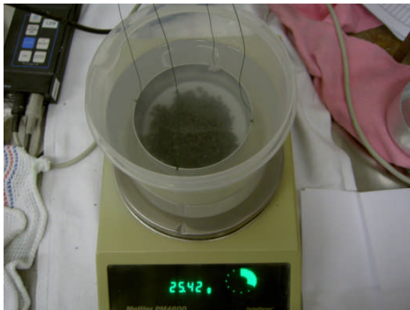
Figur 54: Wägen des Auftriebs von Cuttings
