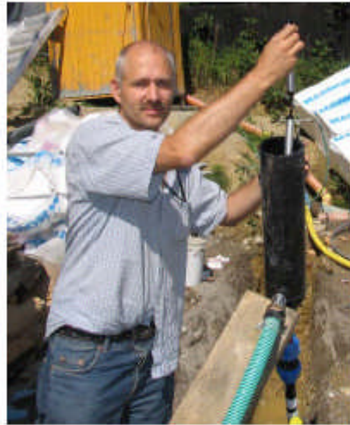
Figur 10: Entnahme der Messsonde aus dem Fänger.
