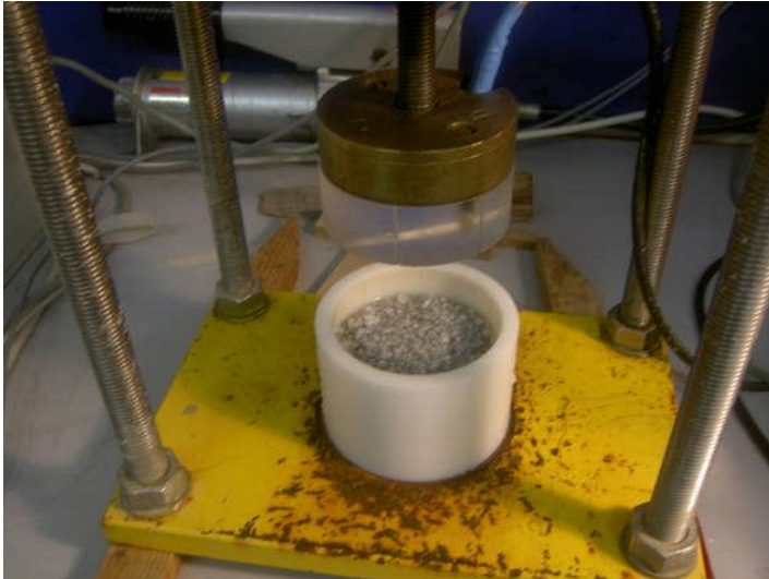
Figur 50: Wärmeleitfähigkeitsmessung an einer Cutting-Probe
