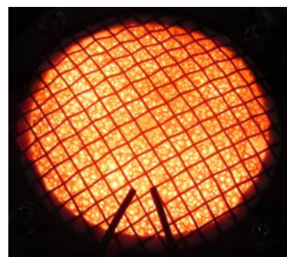
Abb. 3: Konstruktionszeichnung des Porenbrenners für den Einsatz auf der Stirling-Maschine. Rechts: Der Porenbrenner in Betrieb.
