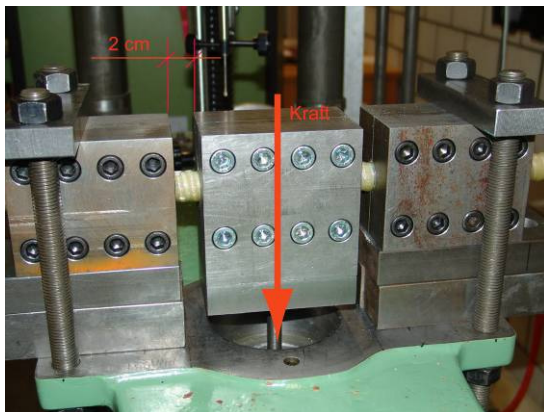
Figur 4: Aufbau für die Bestimmung der Schubfestigkeit.
