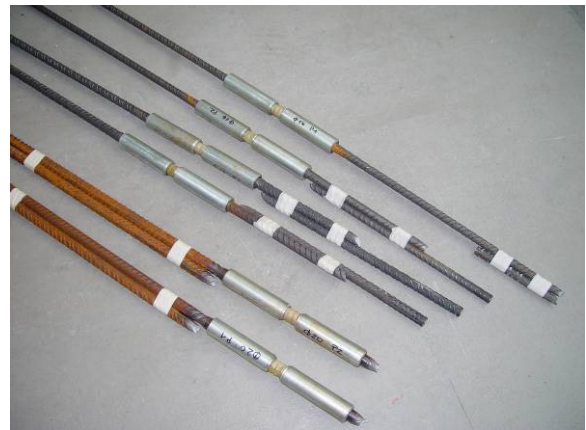
Figur 10: Bruchbilder der Prüfkörper nach dem Zugtest.
