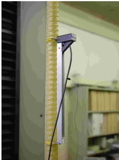
Figur 2: Dehnungsmessung an der Gewindestange.
