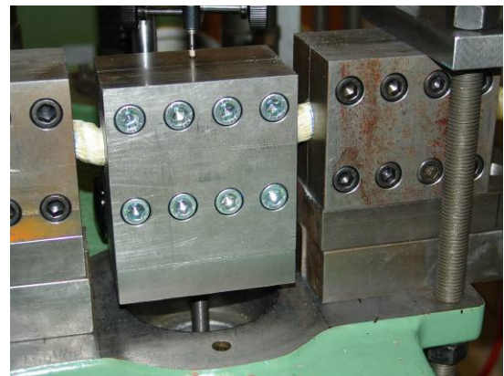
Figur 5: Verformter Gewindestab während der Schubfestigkeitsuntersuchung..
