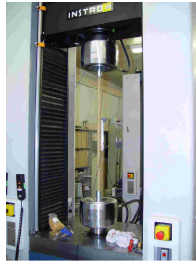
Figur 3: Zugversuch an einer Gewindestange.
