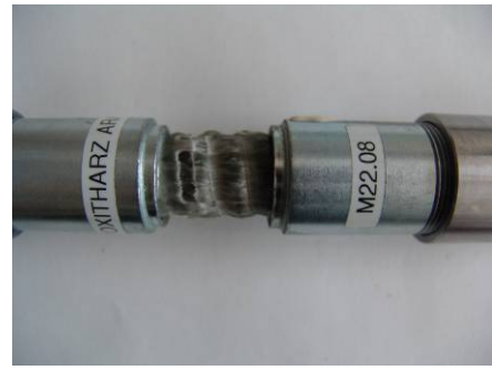
Figur 15: Typisches Bruchbild eines GFK-Gewindestabes nach einem Zugversuch.
