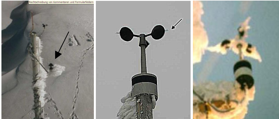
Abb. 6: Verschiedene Vereisungseffekte an Anemometern. Links: Eisansatz am Sensorarm beeinflusst die Messung mit einem beheizten Sensor (Gottshard). Mitte und rechts: Schmelzwasser setzt sich aussen an einem beheizten Anemometer an (Sternstein, Österreich).
