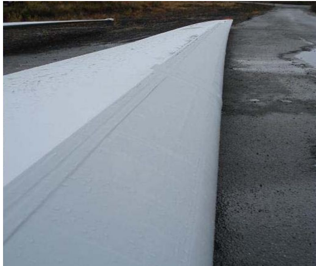
Abb. 15: Heizfolie montiert auf dem Rotorblatt einer Vestas V90 in Schweden.
