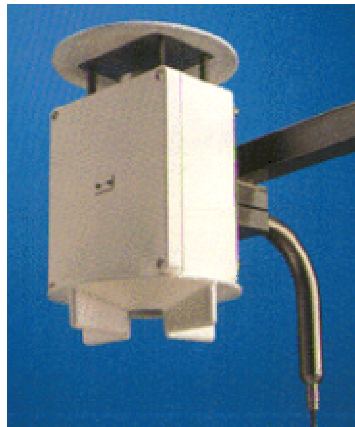
Abb. 20: Thygan Taupunktspiegel-Hygrometer der Firma Meteolabor.
