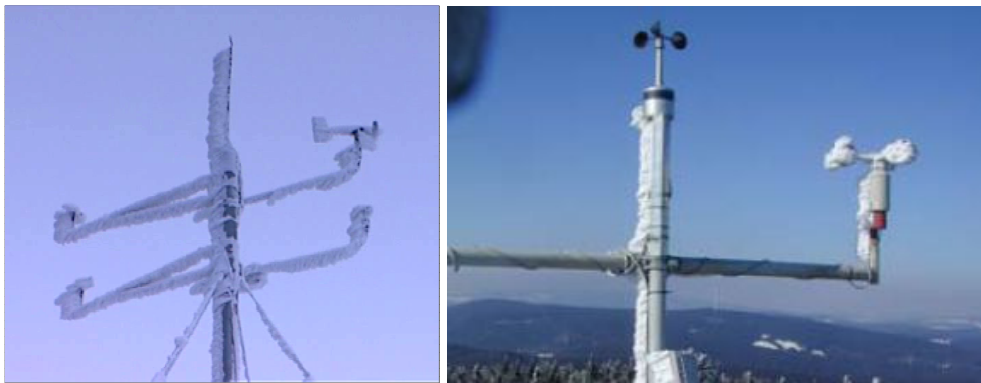
Abb. 4: Links: Vereiste unbeheizte Windmessgeräte an einem Messmast (Matzendorf Stierenberg). Rechts: Vereiste unbeheiztes und eisfreies beheiztes Windmessgerät (Sternstein, Österreich).
