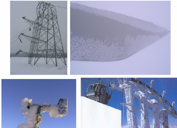
Abb. 1: Die Vereisung an Strukturen betrifft viele Bereiche. Oben links: Wegen Vereisung eingestürzter Mast einer Hochspannungsleitung. Oben rechts: Vereisung am Rotorblatt einer WKA. Unter links: Vereistes Propellernemometer. Unter rechts: Vereisung am Mast einer Seilbahn.
