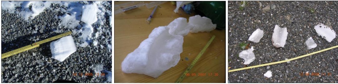
Abb. 16: Fundstücke von Eiswurf von der Enercon E-40 auf dem Gütsch.
