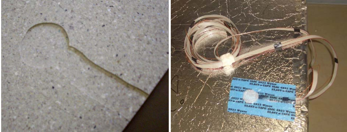
Abbildung 12: Montage der Innendrucksensoren. Links: Aussparung in der PUR-Schicht der Beplankung, rechts: Auf VIP geklebter Sensor (mit Klebfolie geschützt)..
