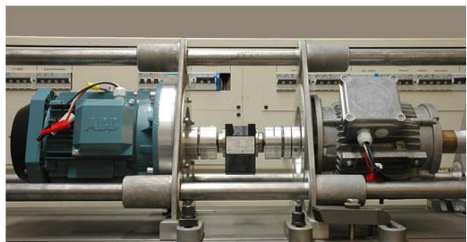
Abb. 17: Mechanische Kopplung der Maschinen ASM ↔ BLDC
