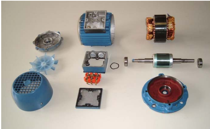
Abb. 21: Ein Normmotor in seine Einzelteile zerlegt.
