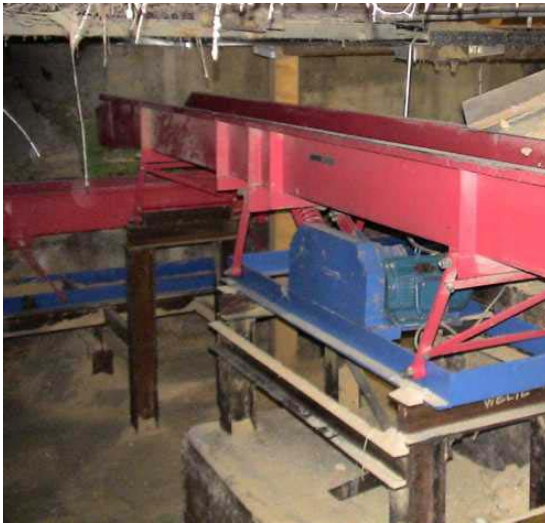
Figur 12: Vibrorinne mit 3 kW Asynchronmotor (türkischer Motor unter der Rinne)
