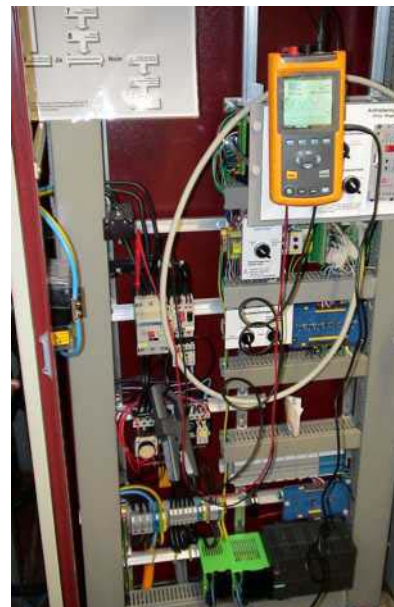
Figur 6: Schaltschrank für den Hydraulikprüfstand mit Leistungsmessgerät (gelbe Farbe)
