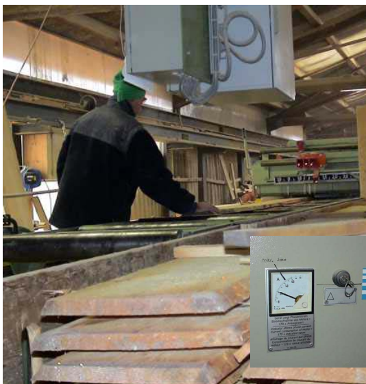
Figur 19: Besäumer aus der Sicht des Maschinenführers und Ausschnitt vom Schaltschrank mit aussen installiertem Stern/Dreieck-Umschalter.
