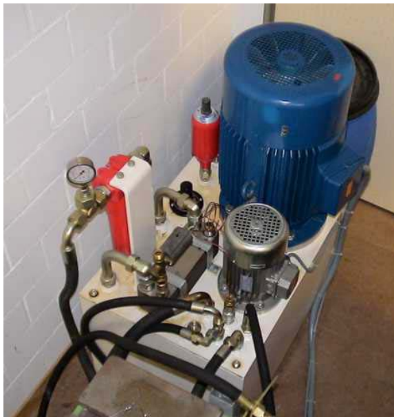
Figur 5: Hydraulikpumpe für Prüfstand mit 22 kW Asynchronmotor (blaue Farbe)
