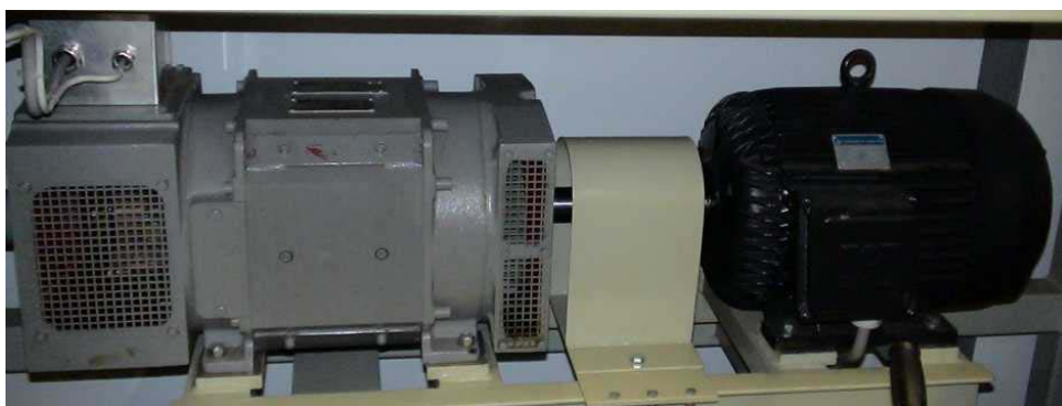
Figur 8: Dynamischer Umformer mit 11 kW Asynchronmotor (rechts)
