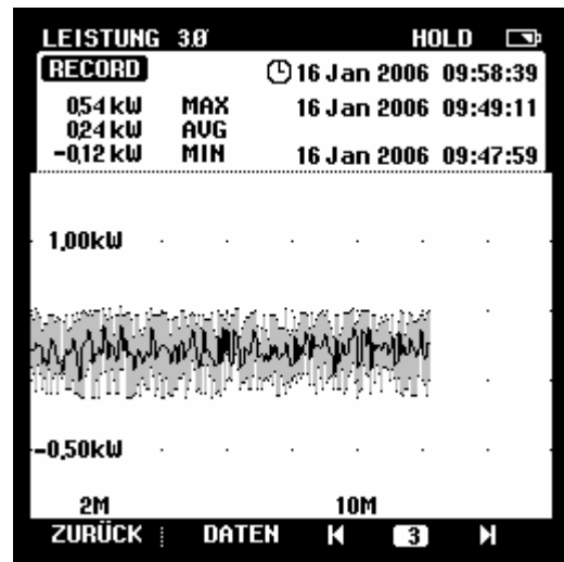
Figur 13: Leistungsaufnahme der Vibrorinne in der Dreieckschaltung, im Durchschnitt 0,3 kW.
