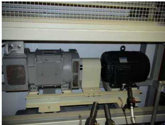
Bild 2) Dynamischer Umformer (AC-DC) mit 11 kW Asynchronmotor
