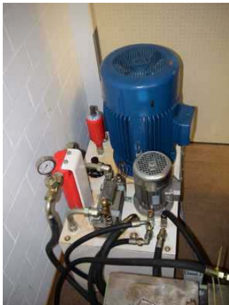
Bild 1) Hydraulikpumpe für Prüfstand mit 22 kW Asynchronmotor
