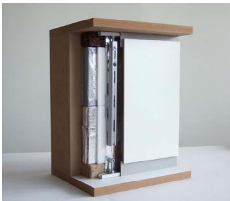
Fig. 1: Arbeitsmodell des Bausystems für Innendämmung mit VIP.
