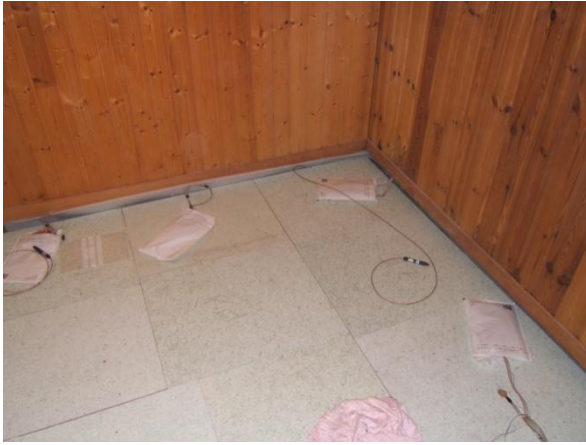
Bild 3: Testraum für Feldmessungen: 15 m 2 VIP-Elemente mit beidseitigem Schutz, bestückt mit Druck-, Temperatur- und Feuchtesensoren.
