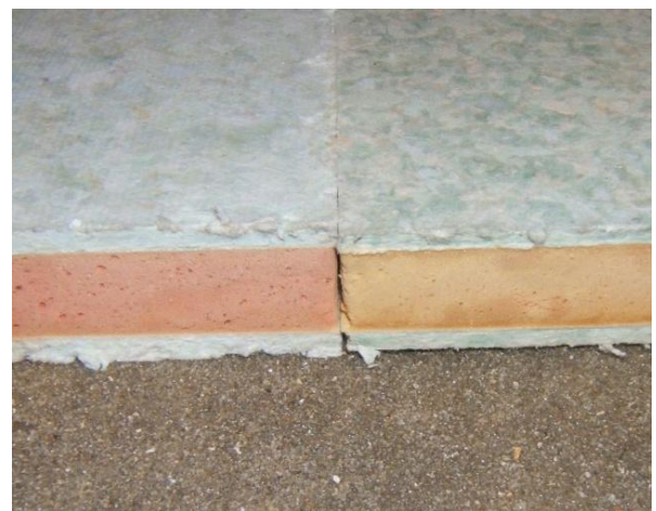
Bild 2: Schnitt durch ein VIP-Element mit beidseitigem Schutz aus Entkoppelplatten aus Polyesterfasern, totale Aufbauhöhe 28 mm.
