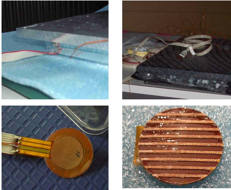
Abbildung 16: Kalibrierung unter Einbaubedingungen (oben), Sensorkopf und delaminierte Kupferplatte (unten).
