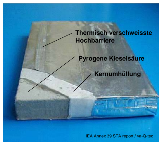
Abbildung 2: Aufgeschnittenes VIP mit Hülle und Pulverkern aus pyrogener Kieselsäure.
