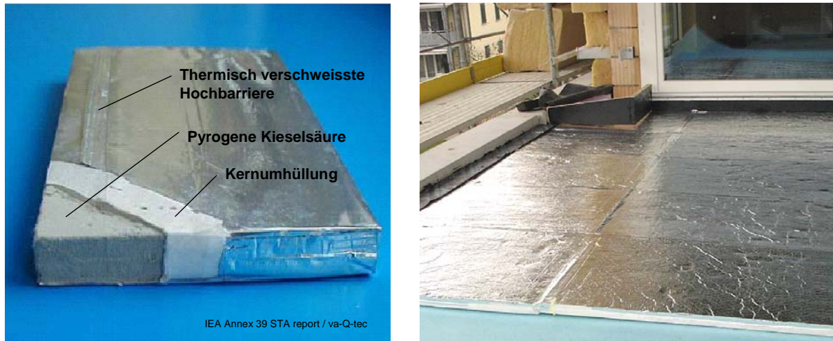
Fig. 1: Bestandteile eines Vakuumisulationspaneels VIP (links), Flachdachdämmung mit VIP (rechts).
