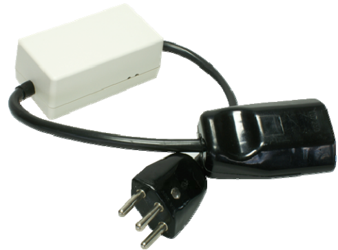
Fig. 9 Links: Prinzipielle Funktionsweise Stehleuchte mit an der Decke Montierten Funk-PIR. Rechts: Prototyp des Funkaktors für Stehleuchten.
