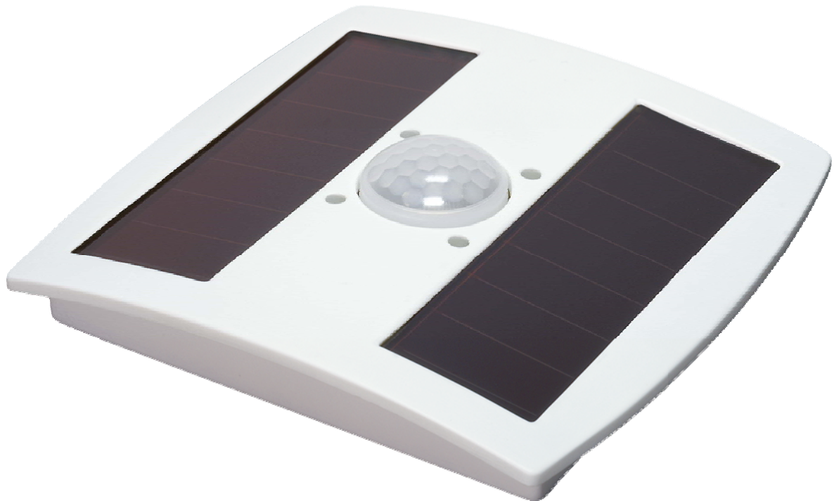
Fig. 2 Der neu entwickelte SENSOLUX Funk-Präsenzmelder. Zwei Indoor-Photozellen (dunkle Streifen) erzeugen die für den Betrieb des Präsenzmelders notwendige Energie.
