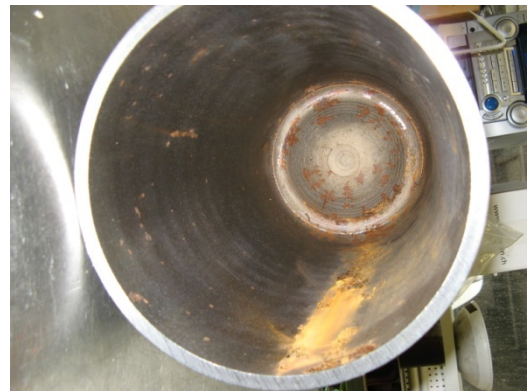
Bild 11: Die geöffnete alte Druckluftspeicherflasche des Einhubtriebwerks mit Korrosionsspuren.
