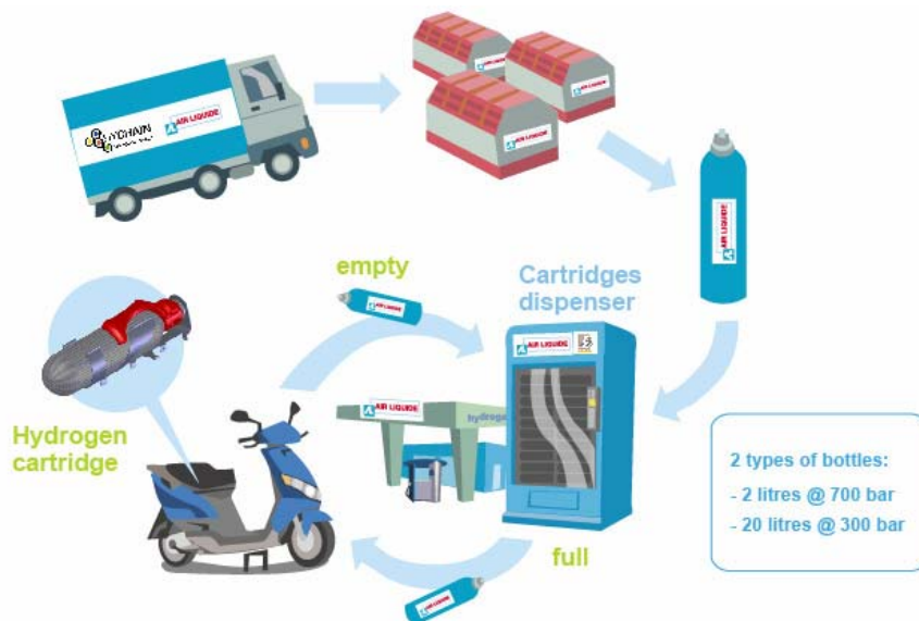
Figure 8: système « Hychain » pour l'approvisionnement en cartouches H_2
