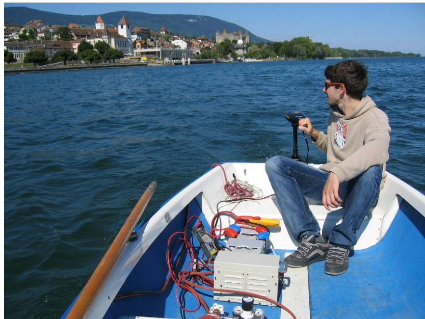
Figure 2: Motorisation pile à combustible en tests sur le lac de Neuchâtel
