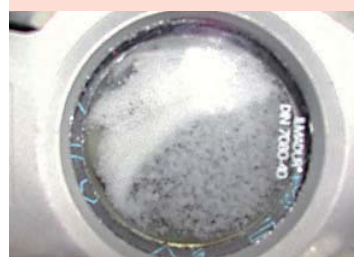
Visualisation du coulis d'hydrates de \text{CO}_2 .
