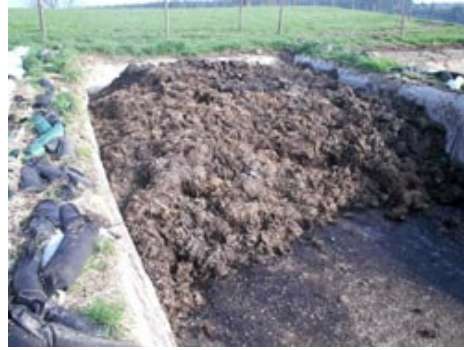
Abbildung 31: Fahrsilo-Fermenter mit Restsubstrat nach Abdeckung der Folienhaube (Quelle 26 ).
