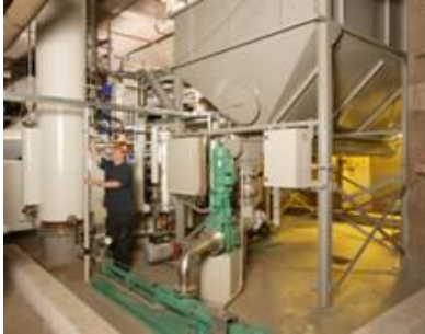
Abbildung 15: ATZ-Verfahren – Pilotanlage zur Vergärung spezieller organischer Reststoffe (Quelle 16 ).
