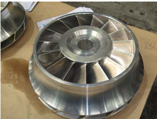
Figur 5: Versuchslaufräder für hohen (links) und mittleren (rechts) Durchsatz
