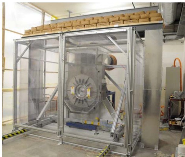
Figur 1: Skalierter Versuchsstand für die experimentelle Simulation der Strömungsverhältnisse in einem luftgekühlten Generator am Standort Fachhochschule Nordwestschweiz [Quelle: Prof. T. Griffin]
