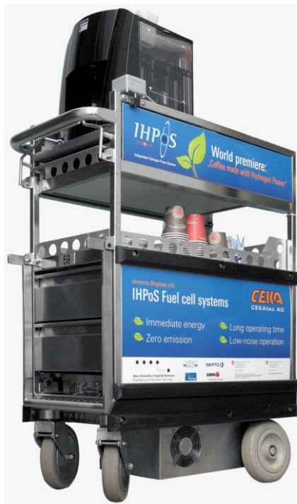
Figur 3: Integration eines luftgekühlten Brennstoffzellensystems zur Versorgung einer Minibar. Elvetino/SBB plant den Einsatz von mehreren solchen Systemen im Jahr 2013. Über mehrer Jahre kann das Brennstoffzellensystem gegenüber der konventionellen Batterielösung in dieser Anwendung wirtschaftlich vorteilhaft sein.
