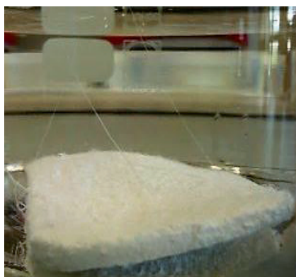
Figur 3: Herstellung der neuen IHT-Membranen: (Links) Polymer-Gewebe, (Mitte) eingetaucht in ein Gemisch aus Polymeren, Lösungsmitteln und inorganischem Füllmaterial, (Rechts) Koagulation der impregnierten Membran. Die notwendige Dicke (2,5–3 mm) wird durch Pressen erreicht.
