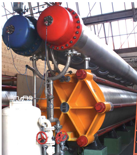
Figur 1: (links) Bei der alkalischen Elektrolyse dient eine 25-prozentige Kalilauge (KOH) als Elektrolyt. Durch das Anlegen einer Gleichspannung wird an der Kathode Wasser zu Wasserstoff und OH - -Ionen zersetzt. Theoretisch sind hierfür 1,23 Volt erforderlich, was der Dissoziationsenergie für Wasser von 286 kJ/mol entspricht. Typische Zellenspannungen liegen jedoch im Bereich von 1,8 bis 2 Volt. Das Ionen-leitende Diaphragma erlaubt den Ladungsausgleich in der Zelle und trennt die beiden Reaktionsgase Wasserstoff und Sauerstoff voneinander. (rechts) Bei industriellen Grosselektrolyseuren werden etliche Zellen in Serie hintereinander geschaltet, so zum Beispiel bei den Hochdruckelektrolyseuren von Industrie Haute Technologie SA, den grössten Druckelektrolyseureinheiten (3 MPa) weltweit mit einer Kapazität pro Einheit von bis zu 760 Nm 3 /h. Das Bild zeigt eine Installation bei der Firma Hrand Djvahirdjian SA ( www.djeva.com/l ), wo Wasserstoff und Sauerstoff in grossen Mengen (bis zu 50'000 Nm 3 pro Tag) zur Produktion synthetischer Edelsteine eingesetzt wird.
