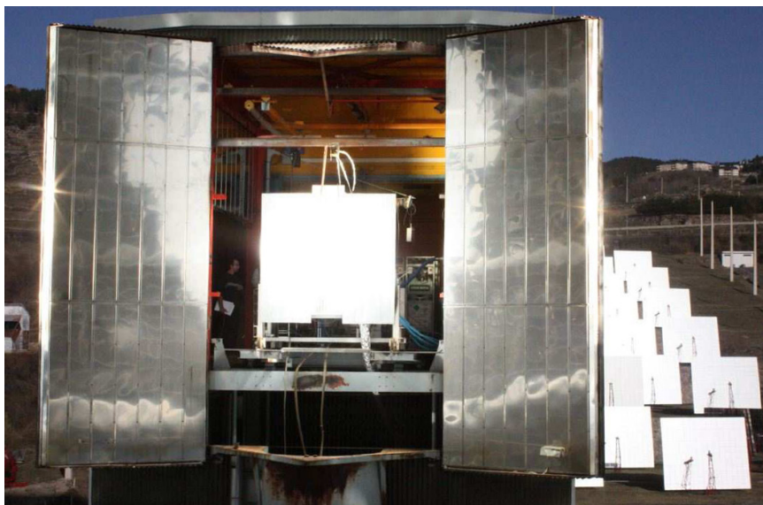
Figur 4: Ansicht der Experimentierplattform am 1 MW-Solarofen in Odeillo (Frankreich) bei geöffnetem Shutter und unter Bestrahlung. Rechts im Hintergrund erkennt man einen Teil des Heliostatenfelds. Im Berichtsjahr wurde am PSI der Reaktor zur solaren Zink-Produktion erfolgreich hochskaliert. Die Tests im zweiten Halbjahr 2011 in Odeillo sollen aufzeigen, ob die theoretisch ermittelten Solar-zu-Zink- bzw. Solar-zu-Wasserstoff-Effizienzen experimentell bestätigt werden können (Quelle: CNRS-PROMES, Odeillo).
