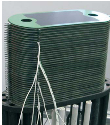
Figur 2: Anodengetragener SOFC-Stapel der Schweizer Firma HTceramix SA (S-Design) mit bis zu 1 kW Leistung mit einer elektrischen Effizienz von rund 47 % bei einer Betriebstemperatur von 780°C (Quelle: HTceramix SA).
