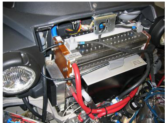
Figur 21: Übersicht über die Einbaupositionen des Stapels im BZ-Fahrzeug SAM [20]
