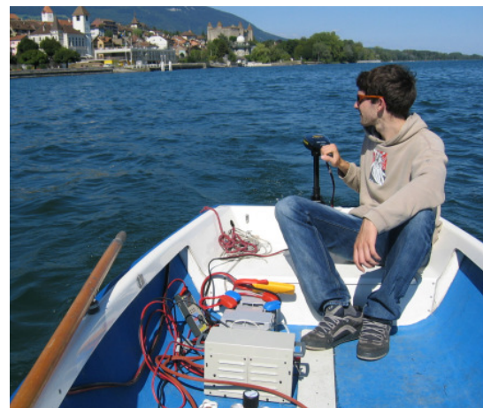
Figur 23: PacBoat: eine 300W PEFC Brennstoffzelle dient als Powersupply für den elektrischen Antrieb eines Fischerbootes Jonson - MinneKota [24]
