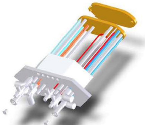
Figur 1: Erster Entwurf eines fortgeschrittenen Test-set-ups für SOFC [1]
