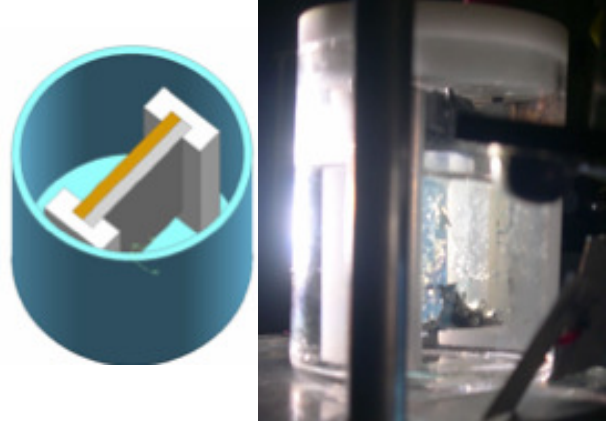
Figur 25: Tisch-Demonstratormodell zur photoelektrolytischen Wasserspaltung mittels Sonnenlicht (WO 3 -Photoanode mit Pt-Kathode und Spannungserhöhung durch Si-Photovoltaikzelle – im Quarzglasbehälter mit 1M H 2 SO 4 als Elektrolyt). [27]
