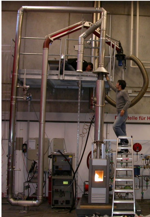
Figur 2 Aufbau des Verdünnungstunnels (Dilution Tunnel, DT) für die Staubmessung an der Prüf- stelle für Holzfeuerungen an der Fachhochschule Nordwestschweiz (FHNW), Mut- tenz.
