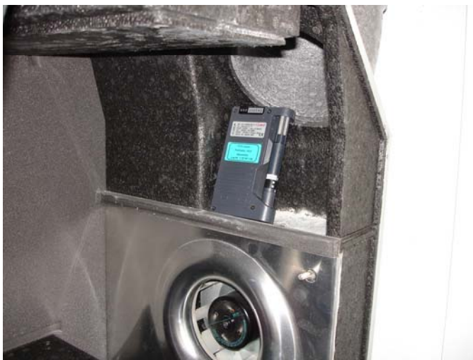
Abbildung 8: Rotronic Datenlogger vom Typ Hygrolog der Prüfstelle HLK im Zehnder Comfoair G90-300.
