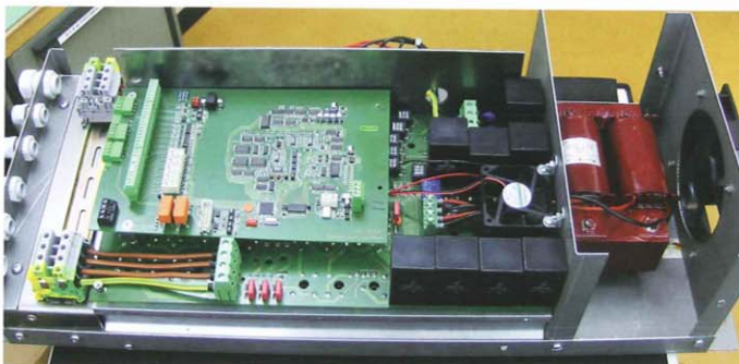
Der Prototyp der neuen Steuerung des Entwicklungsprojekts Neptun ist in marktconformem Gehäuse eingebaut und steht für den Testlauf bereit
