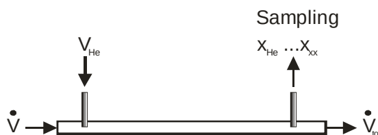
Abbildung 5 Prinzip der Spike-Methode zur Bestimmung des Volumenstroms
