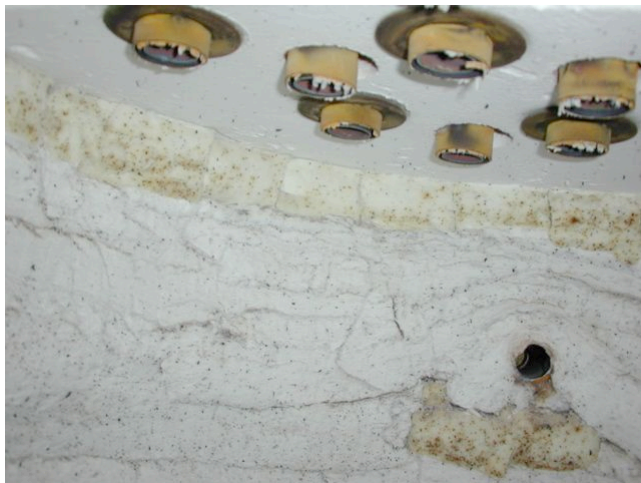
Abb. 7: Blick in Reformer mit Isolation
