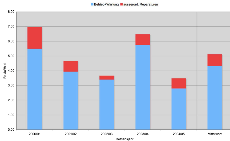
Abb. 23: Anteile planbare Kosten (Betrieb, Wartung) und ausserordentliche Kosten (Reparaturen)
