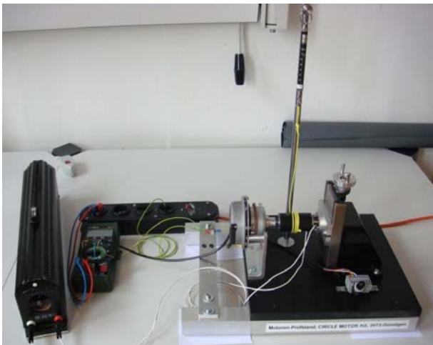
Abbildung 4: Messaufbau zur Bestimmung des Wirkungsgrades eines Kleinlüftungsmotors
