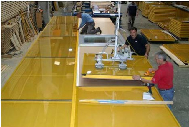
Figur 48: Vorfabrikation der Grosselemente in der Fabrik (links) und deren Montage vor Ort (rechts) [17]
