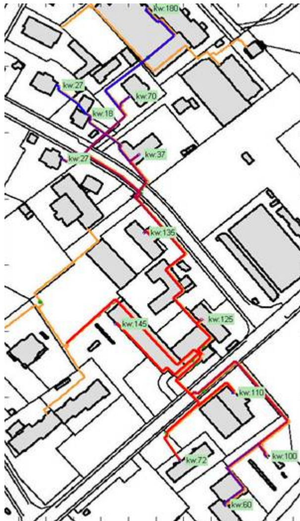
Figure 2 : Plan du sous réseau du quartier des Morasses et puissance des immeubles raccordés
