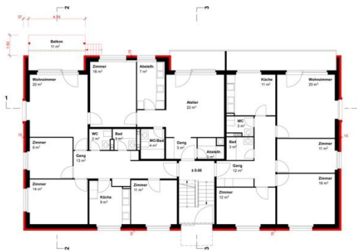
Fig. 18 Grundriss Erdgeschoss (geplant)
