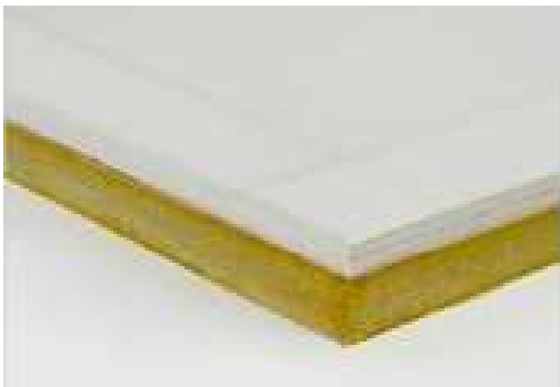
Abbildung 2-2: Aerowolle. Mit Aerogel versetzte Steinwolle) einseitig kaschiert mit Gipskartonplatte zur Untersparrendämmung in sinnvoller Ergänzung zu einer Zwischensparrendämmung bei Dachsanierungen.
