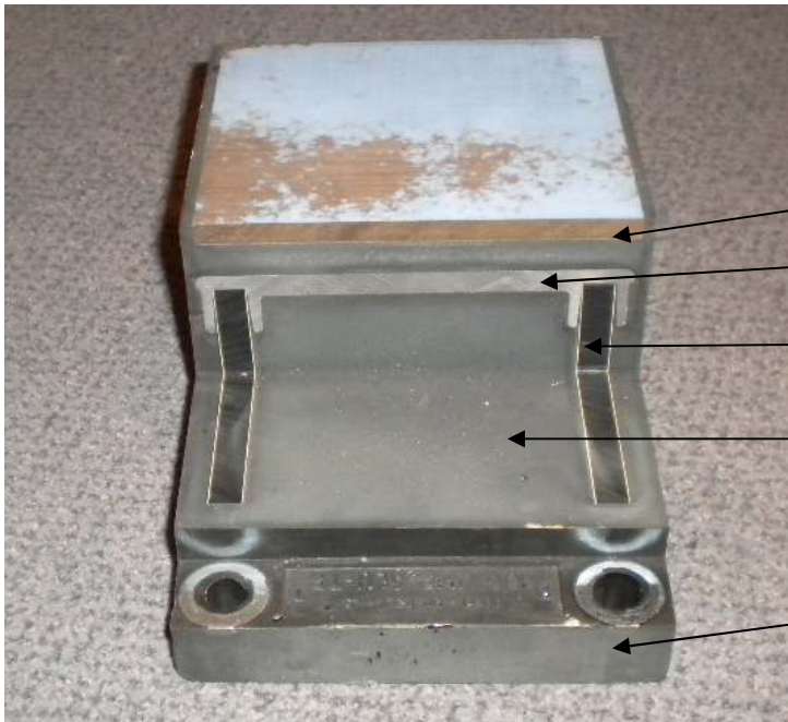
Abbildung 4-52: Schwerlastelement mit aufgeschnittener Montageplatte (Bild Dosteba)
