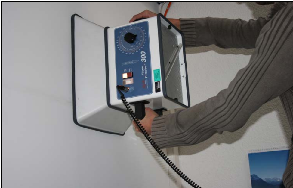
Figur 12: Messung des Luftvolumenstromes mit Flow-Finder
