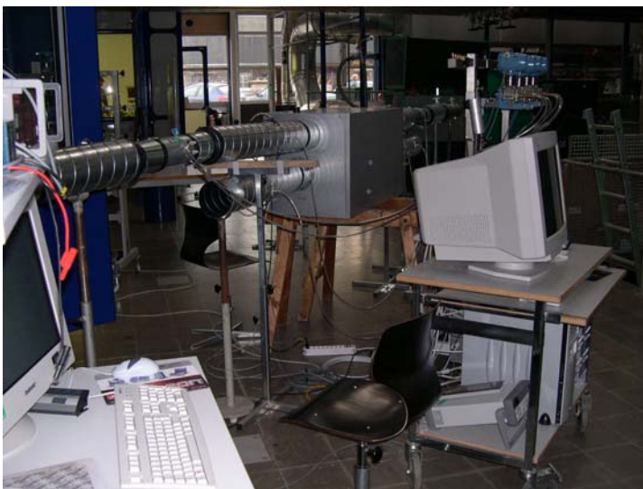
Figur 5: Bestimmung der spez. elektrischen Leistungsaufnahme SFP im Labor
