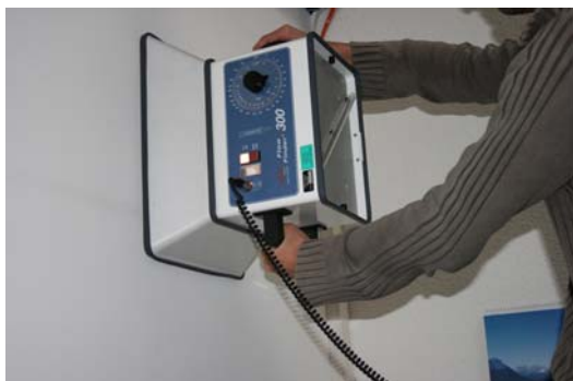
Fig. 1: Messung mit Flowfinder
