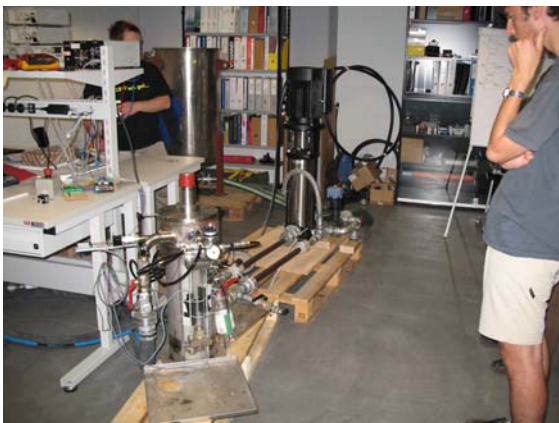
Bild 5 Versuchsaufbau der Universalturbine für die Druckreglertests an der FHNW in Brugg.
